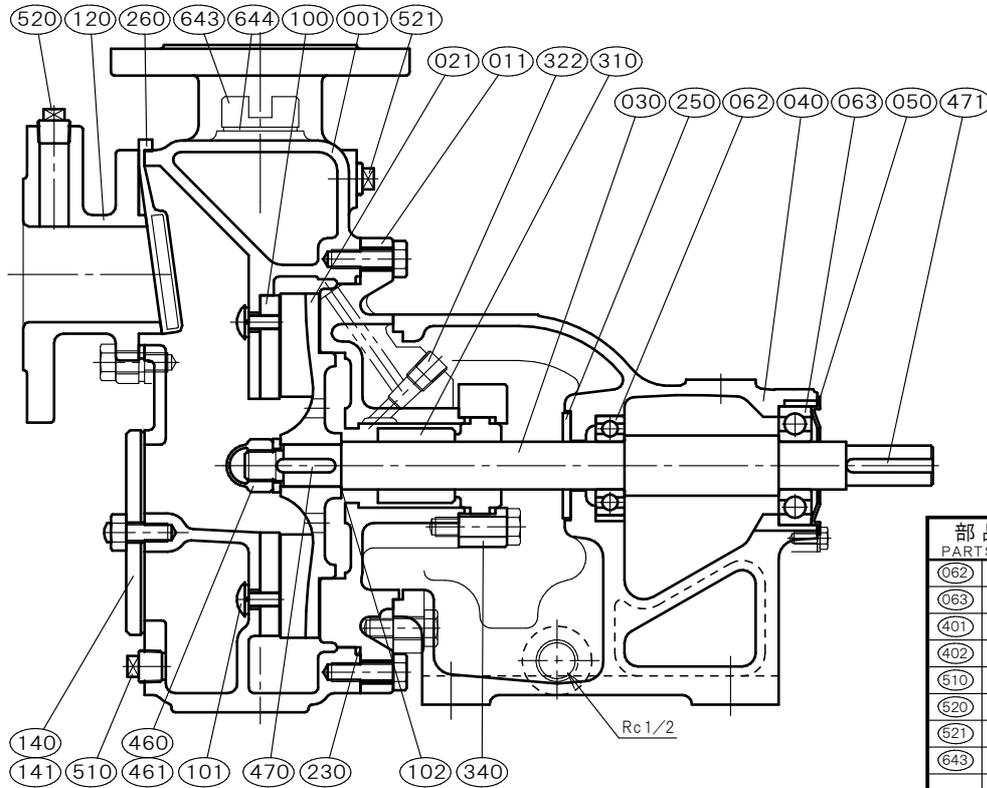
玉軸受は鋼板製シールド又は合成ゴム製シールドを使用しております。但し玉軸受メーカーにより呼び名称が変わります。
