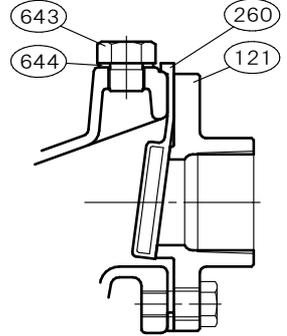
玉軸受は鋼板製シールド又は合成ゴム製シールドを使用しております。但し玉軸受メーカーにより呼び名称が変わります。
