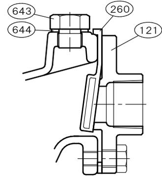
玉軸受は鋼板製シールド又は合成ゴム製シールドを使用しております。但し玉軸受メーカーにより呼び名称が変わります。
