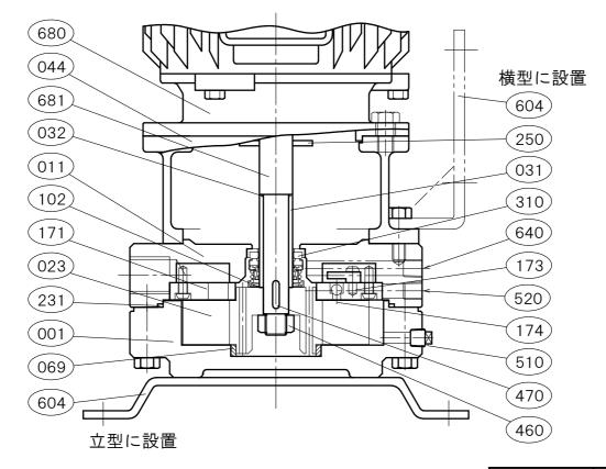
注: ポンプ台は立・横いずれか選択下さい。 WHICH SELECT PUMPFRAME OF VERTICAL OR HORIZONTAL?
