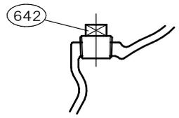
玉軸受は鋼板製シールド又は合成ゴム製シールドを使用しております。但し玉軸受メーカーにより呼び名称が変わります。
