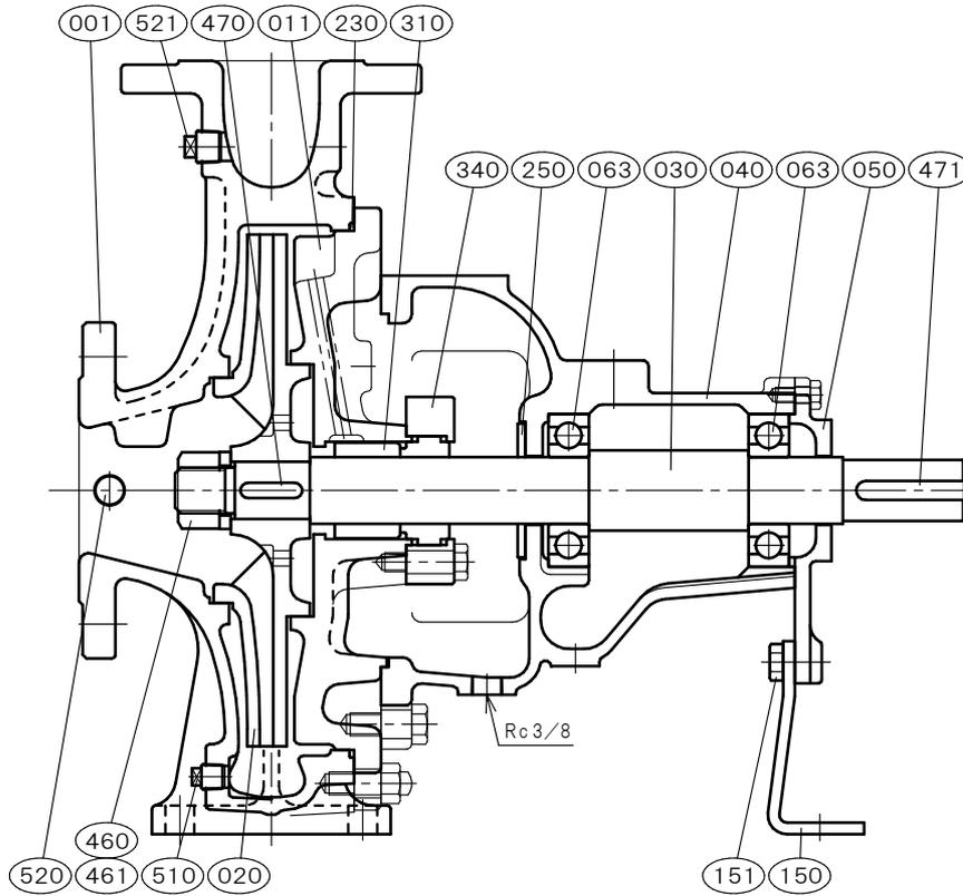
玉軸受は鋼板製シールド又は合成ゴム製シールドを使用しております。但し玉軸受メーカーにより呼び名称が変わります。
