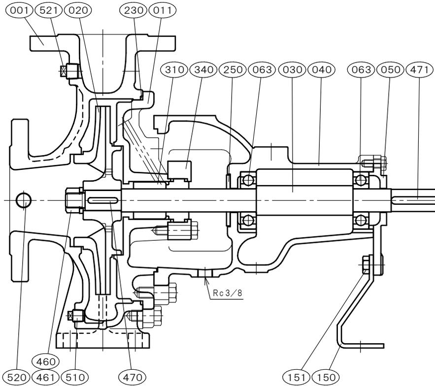
玉軸受は鋼板製シールド又は合成ゴム製シールドを使用しております。但し玉軸受メーカーにより呼び名称が変わります。
