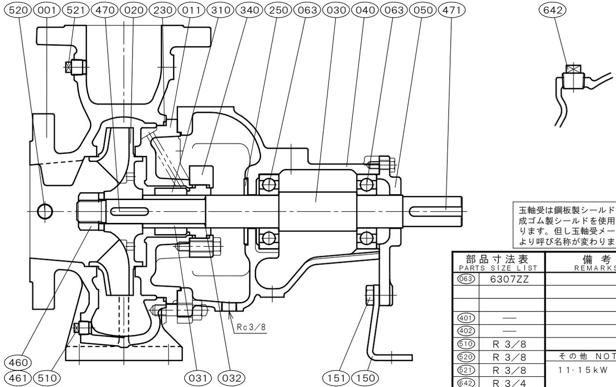
玉軸受は鋼板製シールド又は合成ゴム製シールドを使用しております。但し玉軸受メーカーにより呼び名称が変わります。
