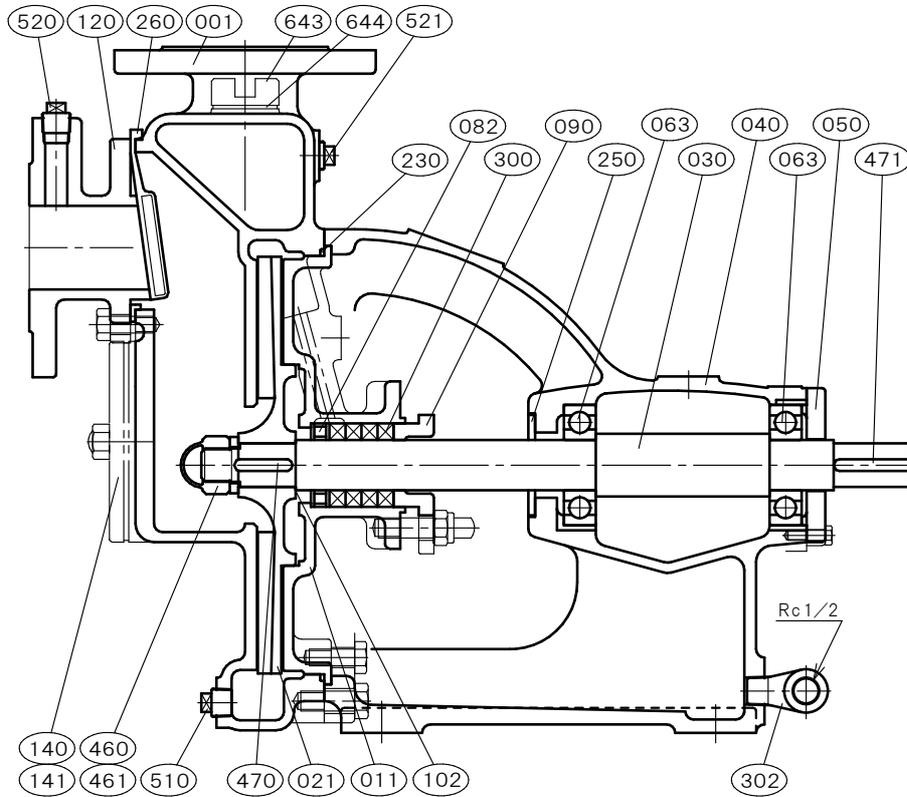
玉軸受は鋼板製シールド又は合成ゴム製シールドを使用しております。但し玉軸受メーカーにより呼び名称が変わります。
