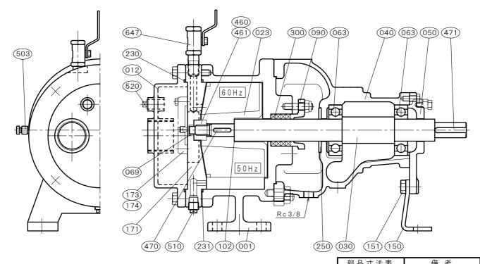
玉軸受は鋼板製シールド又は合成ゴム製 シールドを使用しております。但し玉軸 受メーカーにより呼び名称が変わります。
