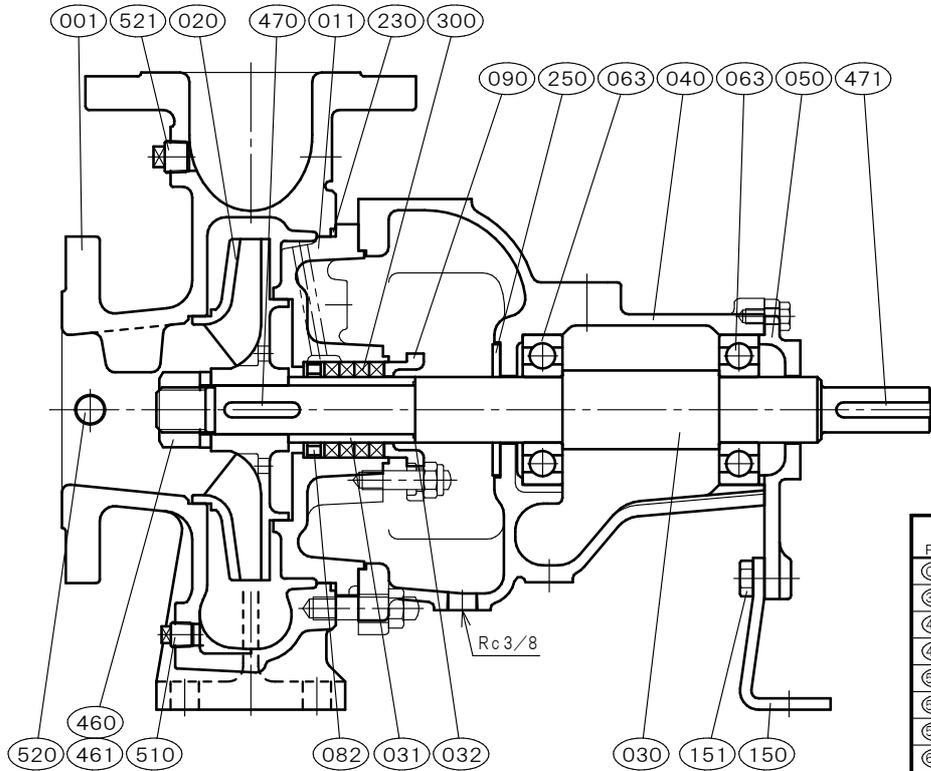
玉軸受は鋼板製シールド又は合成ゴム製シールドを使用しております。但し玉軸受メーカーにより呼び名称が変わります。
