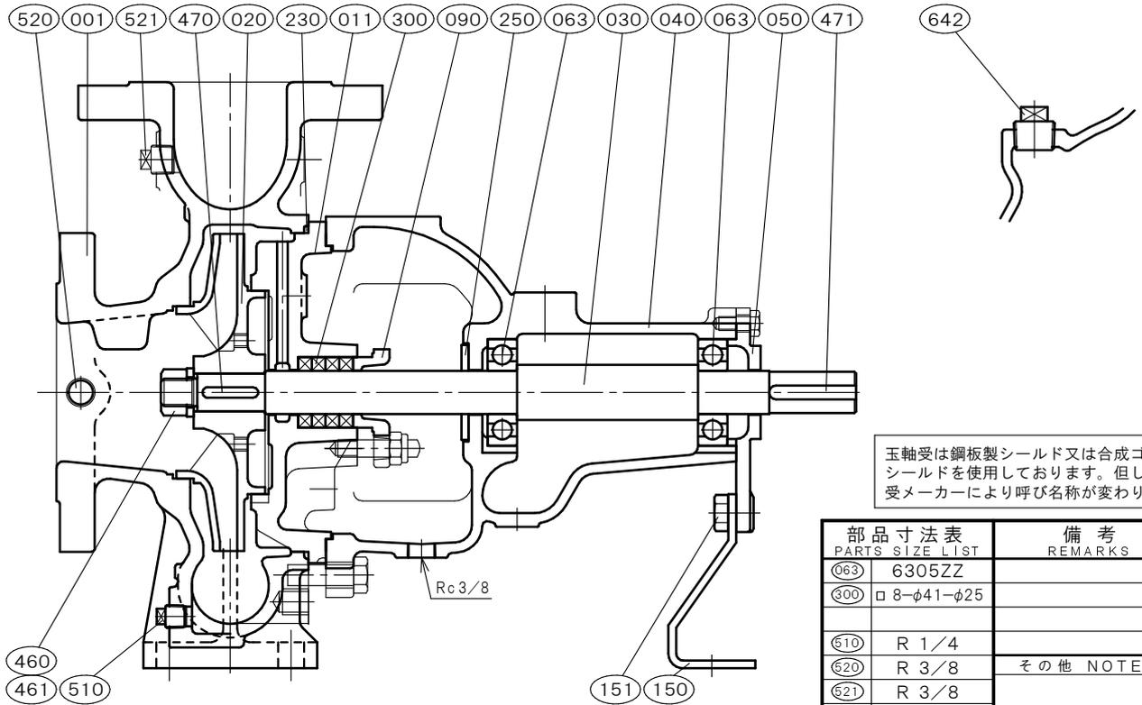
玉軸受は鋼板製シールド又は合成ゴム製シールドを使用しております。但し玉軸受メーカーにより呼び名称が変わります。
